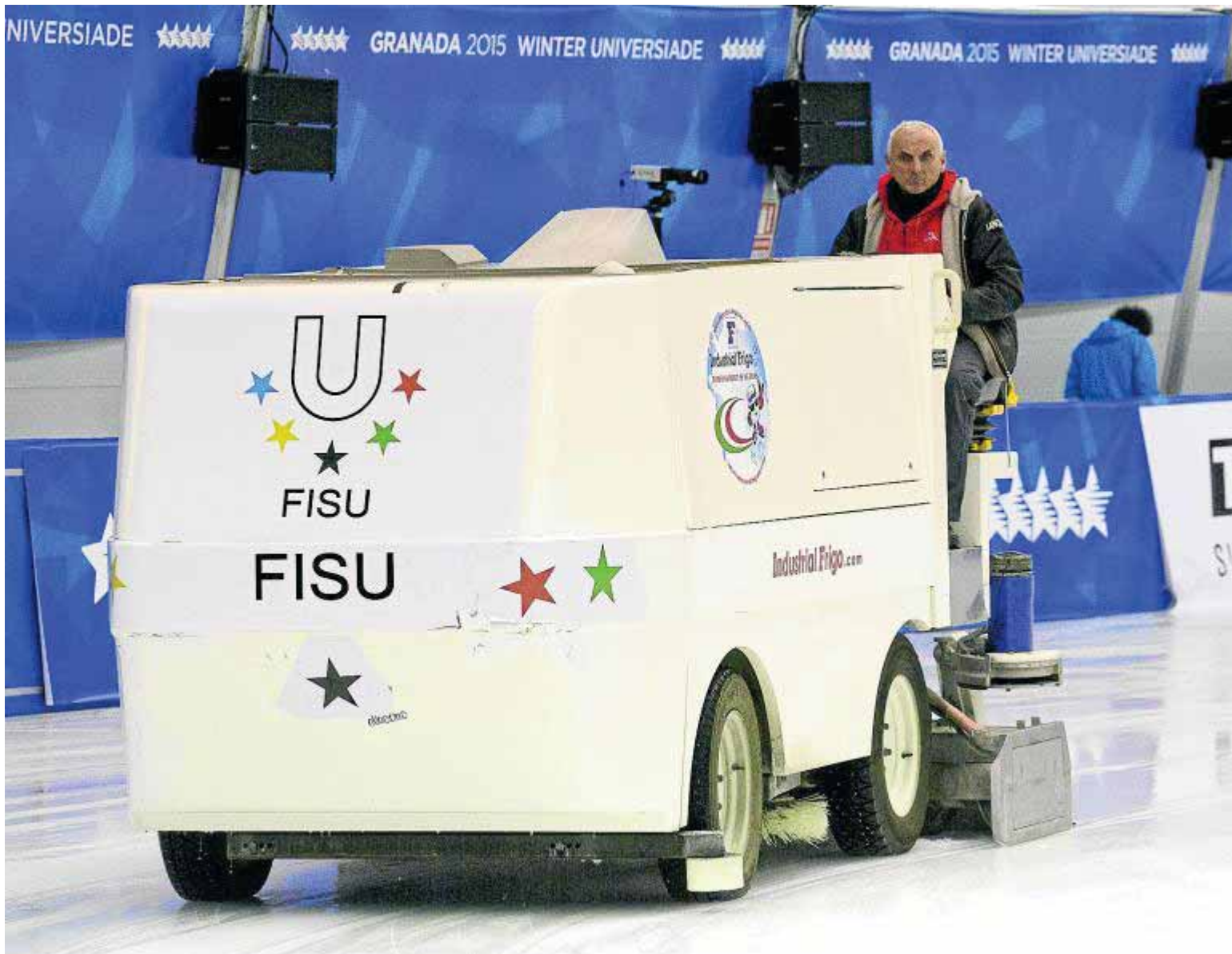
La pulidora rastrilla la capa más externa y después vierte agua caliente para renovar la superficie del hielo. :: GONZÁLEZ MOLERO
