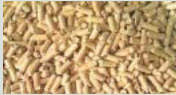
Los pellets son un tipo de combustible granulado alargado a base de madera que se fabrica mediante prensado de serrín. No necesita ni pegamento ni ninguna otra sustancia más que la misma madera. Este proceso le da una apariencia brillante como si estu-
