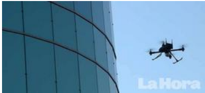
Avance. Los vehículos aéreos no tripulados evitarán el uso de andamios o grúas.
