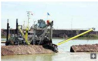
Uno de los barcos-draga que se utilizan para el dragado anual de mantenimiento. En la imagen, en las obras de la nueva esclusa (2009).
