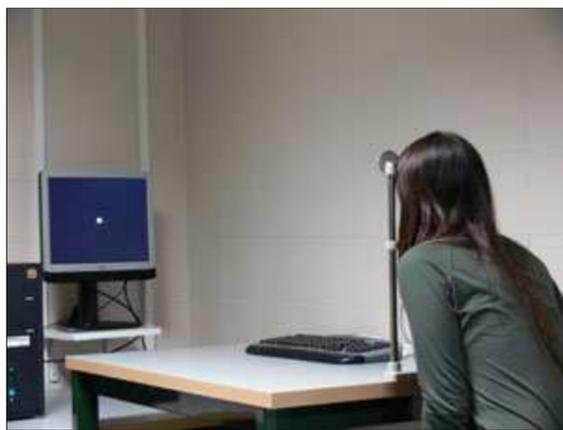
**Test Halo, diseñado por estos expertos granadinos, sirve para medir el deslumbramiento visual**
