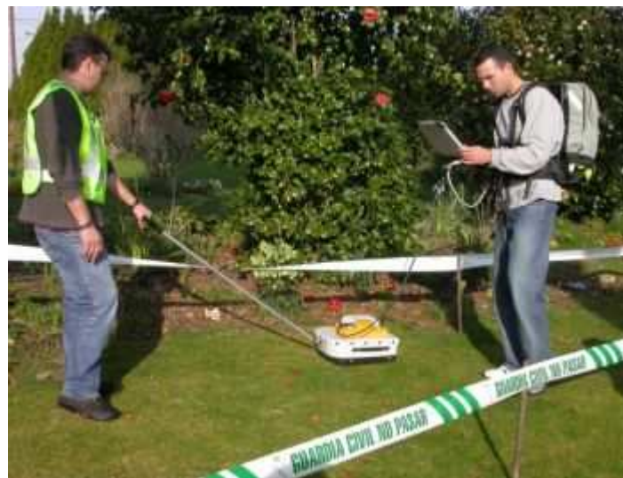
Los expertos pasean el georradar por el terreno para recoger los datos del subsuelo con ondas electromagnéticas.
