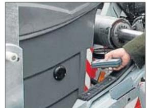
Un mando recoge datos del chip (pieza redonda), en el cubo. TORRES
