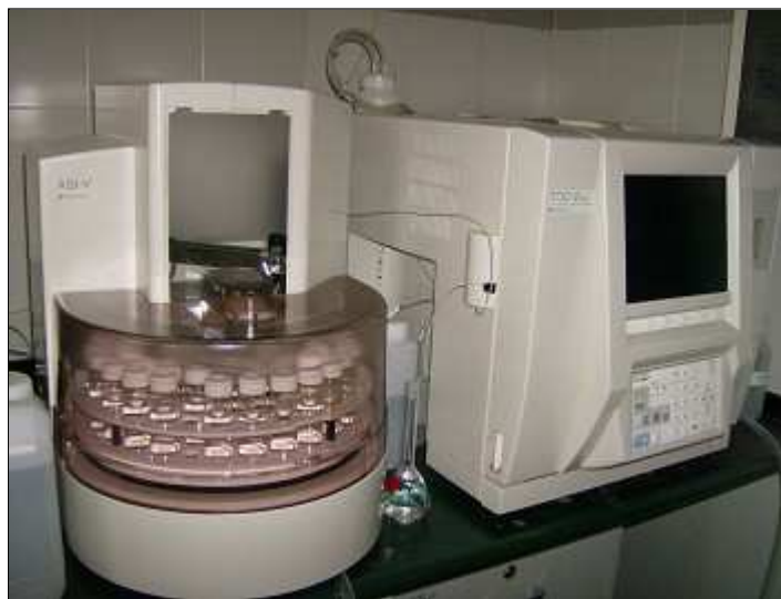
Cromatógrafo, instrumento que sirve para separar mezclas orgánicas complejas e identificar las diferentes sustancias
