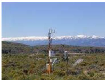
Torre de medición de intercambios de CO2 entre ecosistema y atmósfera mediante la técnica 'eddy covariance'.
