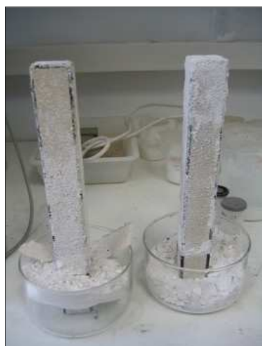
Acumulación de sales sobre rocas
