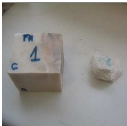
Efectos de la degradación por sales
