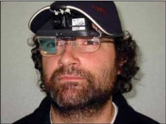
Un hombre prueba el SERBA (Sistema Electro-óptico Reconfigurable de ayuda para Baja Visión), el primer dispositivo de ayuda visual único que puede emplearse en todas las circunstancias y para todas las tareas, sea cual sea el grado de discapacidad del paciente, y que ha sido desarrollado por un grupo de investigadores de la Universidad de Granada, en colaboración con la de Murcia.
