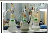
Une équipe de chercheurs de l'Université de Grenade (UGR) a développé une nouvelle méthode de purification des eaux, sur laquelle se sont déjà intéressés plusieurs entreprises et centres de recherche. Il s'agit d'un système basé sur l'utilisation simultanée d'ozone et de charbon actif, hautement efficace pour le traitement des eaux destinées à la consommation humaine. Cette technique est notamment plus rapide et plus fiable que les procédures existantes sur le
