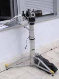
Das in Wien entwickelte Telephotometer zur Messung der atmosphärischen Abschwächung der Lichtstrahlung.
