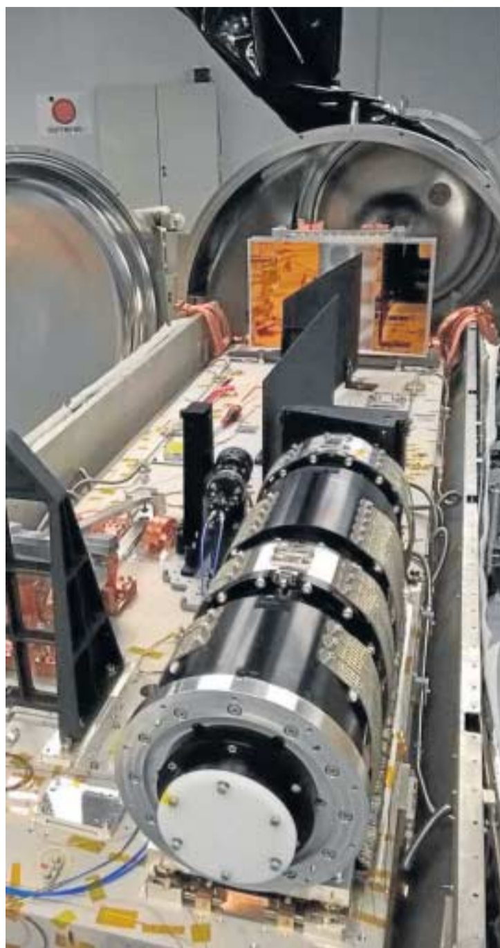
CARMENES, durante su integración en el tanque de vacío.
